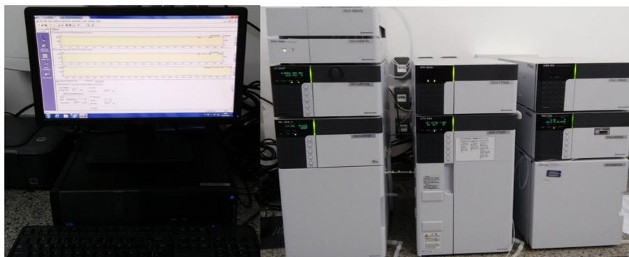
**Figura 4.** Equipamento de Cromatografia Líquida em Alta Eficiência
